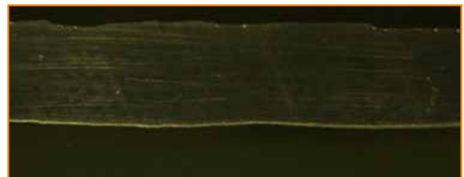
Reparaturschweißung mit DualWave geschweißt. Deutlich weniger Poren.
