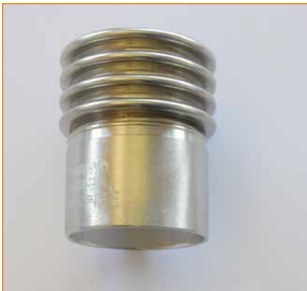
Rundschweißung | Brenner handgeführt (3,0 mm an 0,2 mm)
