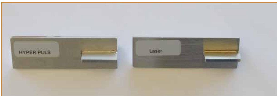
Ecknaht für Pharmatechnik | ohne Zusatz, handgeführt
